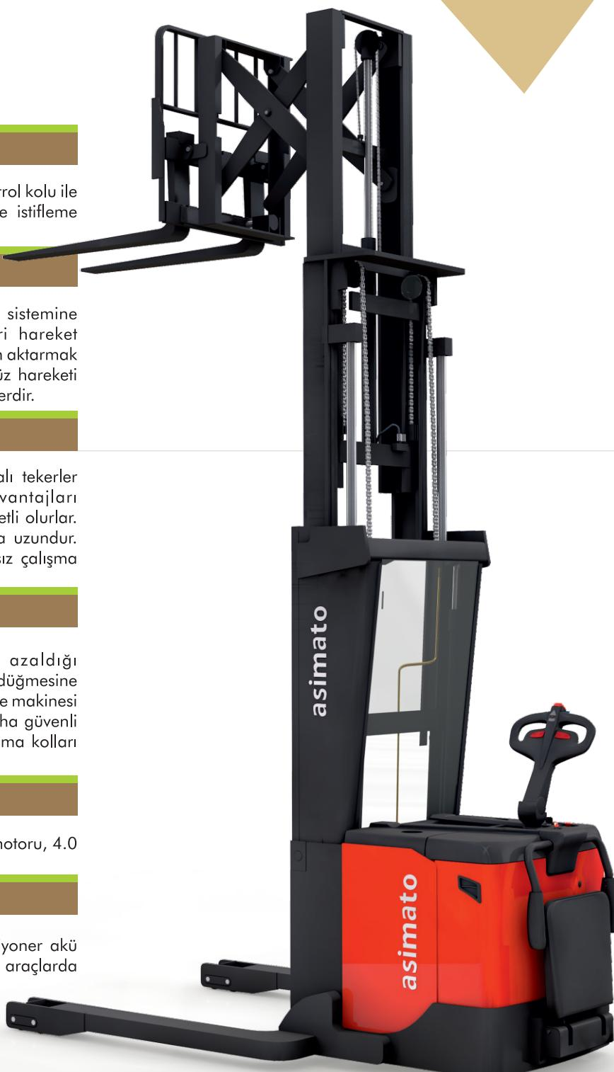
Yük taşımak ve istifleme yapmak amacıyla kullanılır. Akü ile çalışır. Depolarda, süpermarketlerde, kimya tesislerinde kullanıma uygundur. Modern tasarımını operatöre konforlu bir sürüş sağlar. İstifleme makinesi hareket ettirilmeden belli bir mesafeye kadar malzeme ileri geri taşınabilir.
